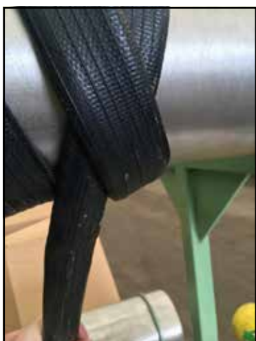
Slika 13: Vozel na koncu tesnilne cevi SAVA
