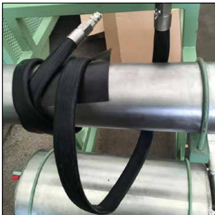
Slika 24: Odstranjevanje tesnilne cevi SAVA
