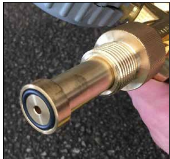
Slika 4: Zapiranje razbremenilnega ventila (levo); tesnilo v polnilnem priključku (desno)
