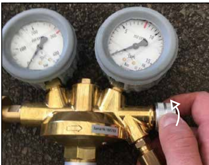
Slika 19: Odpiranje razbremenilnega ventila na reducirnem ventilu
