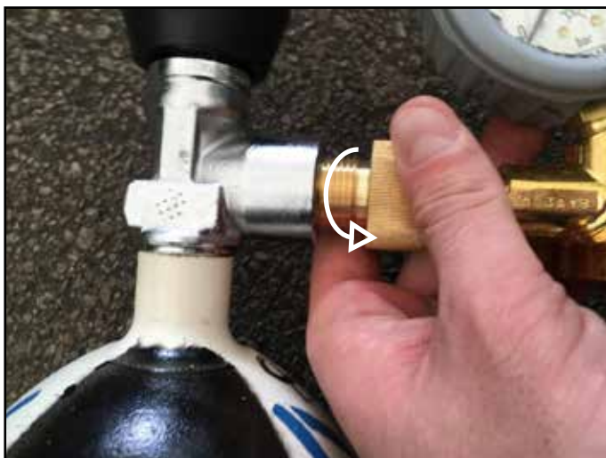
Slika 9: Odvijanje reducirnega ventila s tlačne posode
