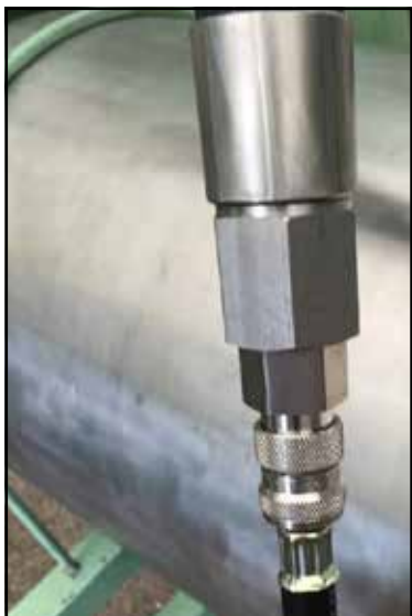
Slika 17: Polnilna cev je priključena na tesnilno cev SAVA
