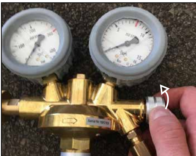
Slika 4: Zapiranje razbremenilnega ventila (levo); tesnilo v polnilnem priključku (desno)
