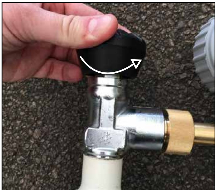
Slika 8: Zapiranje ventila na tlačni posodi
