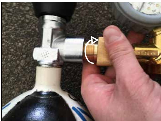
Slika 5: Nameščanje reducirnega ventila na tlačno posodo
