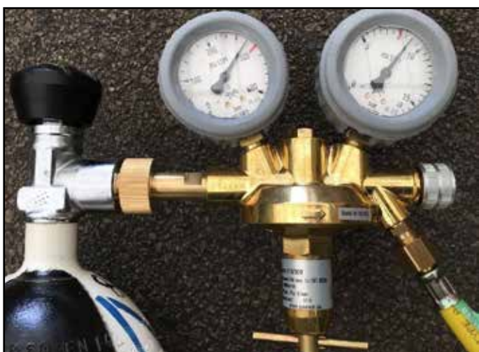
Slika 6: Tlak v tlačni posodi (levi manometer) in nastavljeni znižani tlak (desni manometer)
