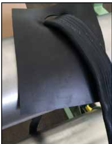
Slika 12: Tesnilna plošča je nameščena preko mesta poškodbe
